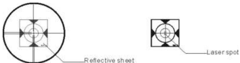
4) Inserire schermo test del segnale EDM.
